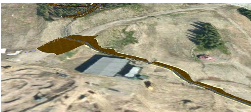
Utsnitt av modell som viser flomveg sør for heishus.
