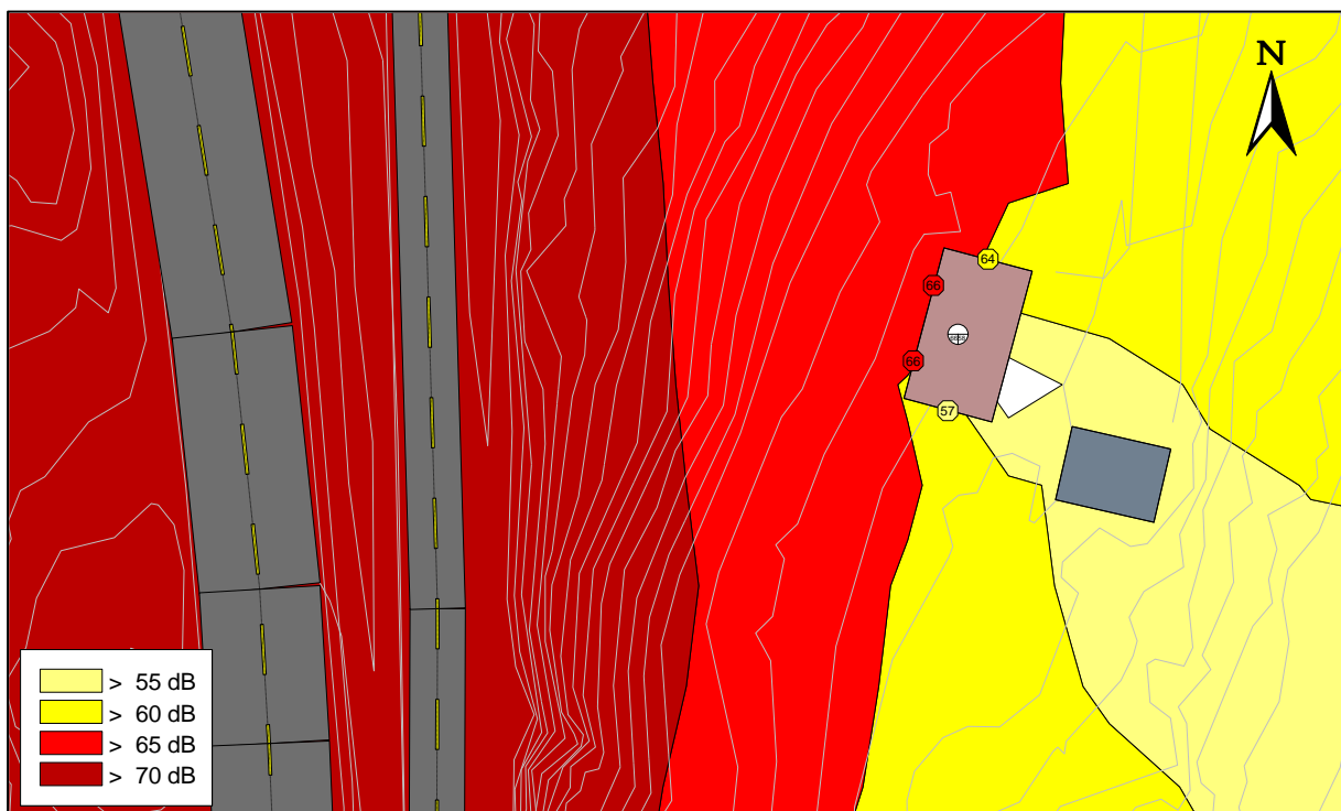
Figur 4-1: Beregning uten planlagt gangvei, med ÅDT 1400 kjt/døgn på Hundervegen. Støysoner L den beregnet 4m over terreng.
