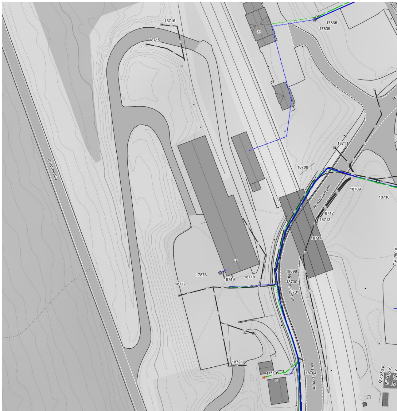
Figur 20: Ledningskart langs Musdalsvegen og gjennom jernbanebru.
