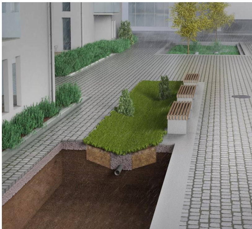
Figur 36: Eksempel hentet fra Leca.no på helhetlig overvannshåndtering med permeable eller, vadi/grasskleddede forsøkninger og drenering.
