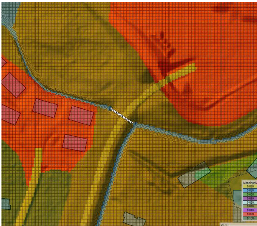
Figur 4-13: Celler i den hydrauliske modellen, sammen med kulvertløp, her vist for Nørdre Slåbekken, Manningsverdier er vist i bakgrunnen.
