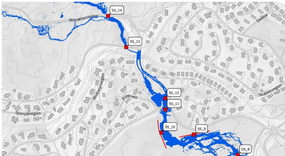
Figur 6-4: Flomsone inkludert tiltak for nedre deler av Søre Slåbekken. Røde streker indikerer voller
