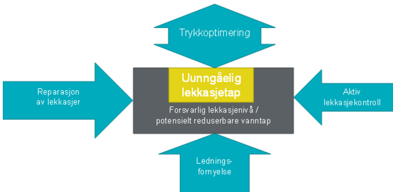
Figur 6-10 - Generelle aktiviteter for å oppnå og beholde tilfredsstillende lekkasjenivå (basert på referanse (38))
