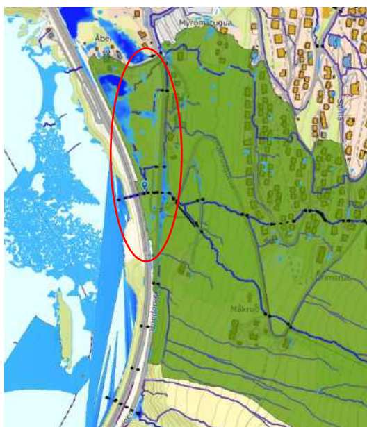
Figur 208: Antatt nedbørfeltgrenser til stikkrenna L.4.
