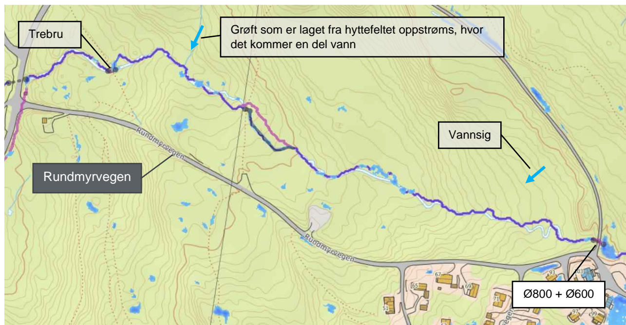
Figur 234: Strekket langs nedre del av Rundmyrvegen meandrerer, og det er få tegn til erosjon og vann på avveie, muligens fordi det er myrområder på begge sidene av bekken som demper og sprer vannet. Bekken går under røtter og i grunnen, som er positivt med tanke på at det demmes opp små fordrøyningsvolumer. Bekken sprer seg også på deler av strekket, og vil antakelig dele seg mer i en flomsituasjon.
